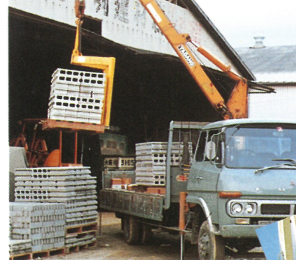
ユニック車で建築資材の運搬に
