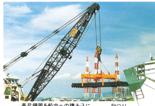
長尺鋼管を船内への積み込みに 5tつり
