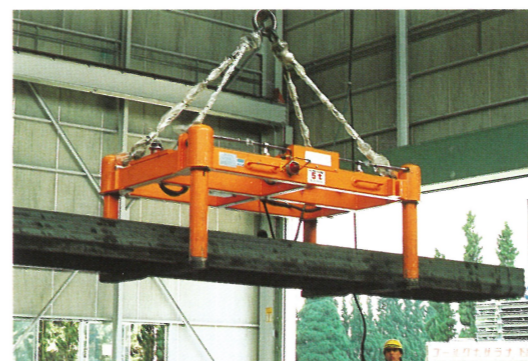
長尺鋼材をトラックからの積み下ろしに(電動式)
