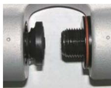
締め付けが完了していない状態 (赤いラインが見える)
